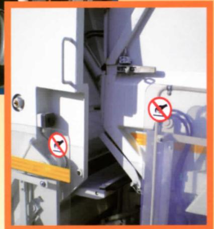
Aparato de descarga en altura con deslizamiento posterior y levantamiento del cajón.
