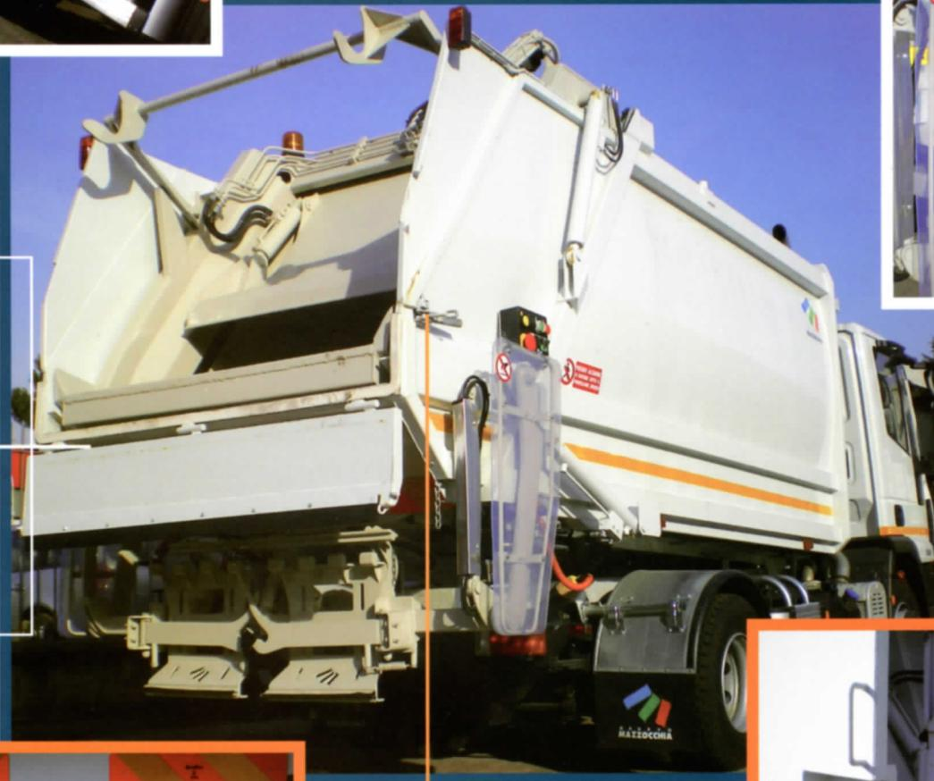
Sistema de cierre de la orilla posterior ajustable, con dispositivo antidesenganche.
